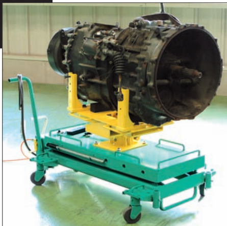
爪部はボルト固定フリータイプのため、小型～大型まで多様なミッションに対応 爪部の金属面が直接ミッションに当たらないゴムパット(オプション)を用意
