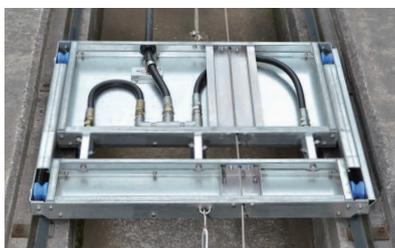
多段ポンプをリールユニットへ内蔵し、水を供給します。高圧温水洗淨機や回転ノズルの洗淨音が気になるお客様にも安心の低騒音。本体・リールユニット内部はムダを省いたシンプルな構造で動作トラブルを防ぎ、メンテナンスも簡単です。
