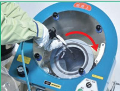
円筒型のエレメントは電動回転させることができ、吹きつけもラクラク
