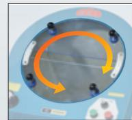
回転式防塵カバー(手動式)で飛散粉塵を防ぎ、安全性と作業性を向上。
