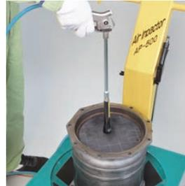
エアインパクトガンのノズルをフィルター面より1cm～3cm程度離して、ゆっくり移動させながら、パルスエアを放射します。(両面清掃)
