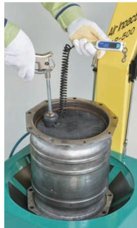
DPFのフィルター面にゴムカップを押し付けてエアブローし、通気抵抗を計測。測定は清掃前と清掃後に行い、清掃度が合格基準を満たしているかどうか、数値で簡易チェックできます。
