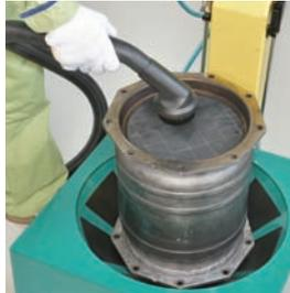
付属のブラシ付きノズルをバキュームクリーナーに接続。先にDPF端面のフランジ内周部や、フィルター表面のダストを吸引除去します。
