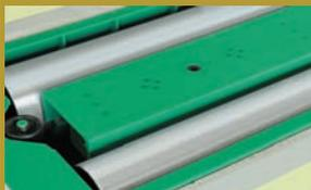
ローラー表面に無数のくぼみをつけたサイレントタイプ。ソフトな接触でタイヤに優しく、金属摩擦音を低減。騒音対策に取り組みされている工場にオススメです。
