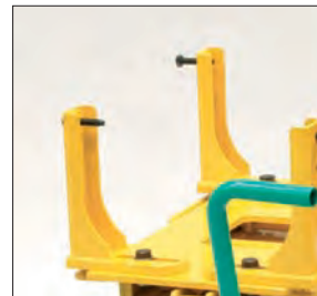
爪部はボルト固定フリータイプのため、小型～大型まで多様なミッションに対応
