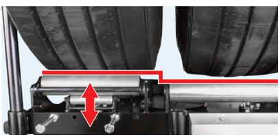
昇降機能付き分離ローラーを上昇させ、段差を付けることによりダブルタイヤのシングル外しが可能！
