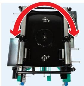
回転解除ハンドルを下げると、受け台が180°回転！受け台の両端で前輪2軸車のタイヤ及び、ダブルタイヤのシングル外しが可能に！
