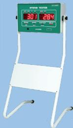
ワイヤレスリモコン操作により、スイッチひとつでサイドスリップ、ブレーキ、スピードに切り替えられ、運転席からもラクに操作できます
