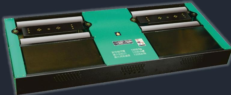
サイドスリップの測定開始と同時に踏板ロック装置が自動解除
