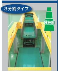
3分割でさらに多彩に!小型車〜大型 車まで車両に合わせてリフトのサイズ をカスタマイズできます。
