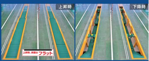
小型車から大型車まで、整備する車の横幅に合わせて使用するリフトを選べるので、1台のフロアリフトで多車種の整備が効率良くできます。
