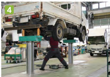
垂鉛メッキ仕様の“4柱式ツインパワーリフト”は大型車はもちろん、小型トラックを2台同時に整備することが可能で作業効率向上
