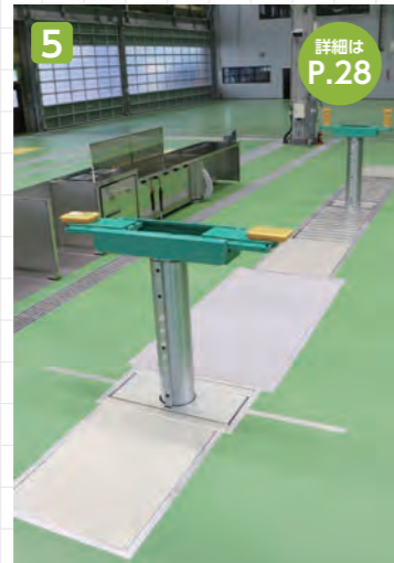
ミッションなどを取りはずす際に便利な鉄板を埋め込んだ“2柱式ツインパワーリフト”
