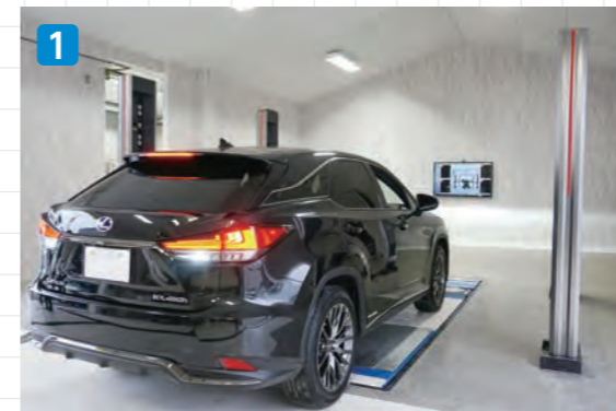
アライメント仕様でドライブオンタイプの“マルチアライメントリフト”を設備
