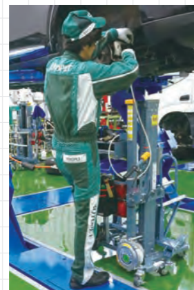
左足でペダルを踏み圧送することで1人でもエア抜きが可能
