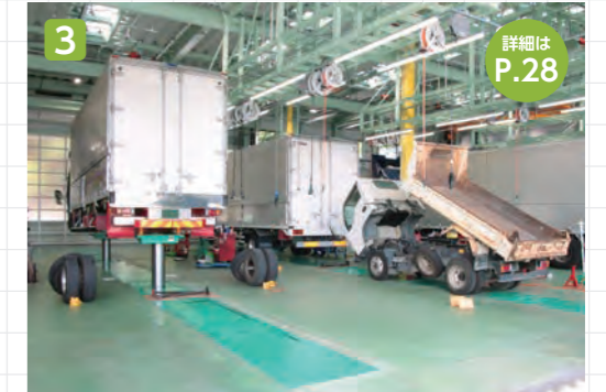
“4柱式ツインパワーリフト”は、1ストールで中・小型トラックを2台同時に整備できるなど省スペース化に大きく貢献
