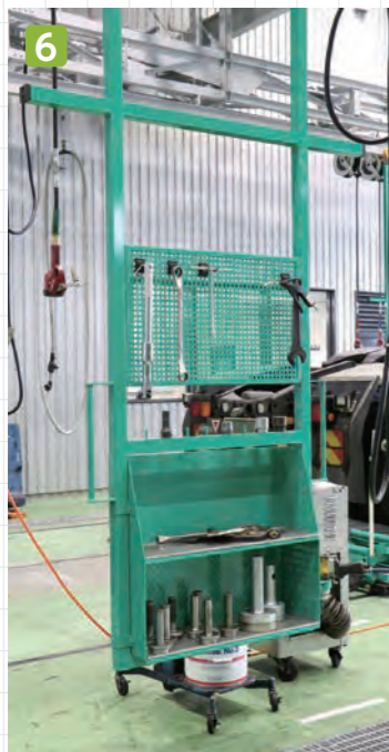
“吊り下げ工具ボード”は必要工具を設置することでメカニックの作業負荷軽減に寄与
