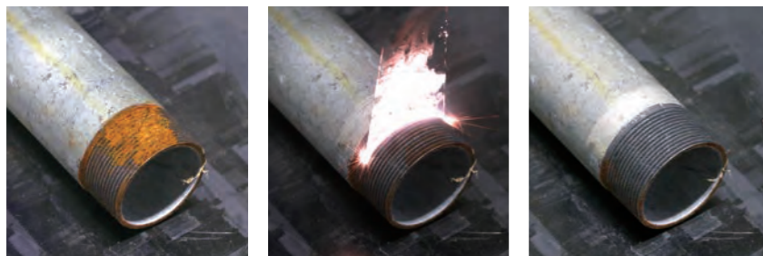
施工前 錆びたねじ山にレーザークリーナーを施工 施工後
