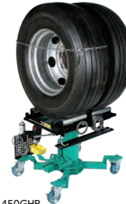
AWD-450GHB 分離回転ローラーを搭載! 回転解除ハン ドルを下げることで、受け台を180°回転 可能に
