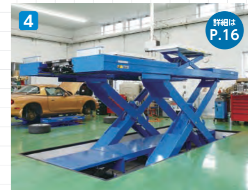
ビッグユースドライブオンリフト“BUD60U”を新設。クラス最高となる6トンの能力でレッカー車整備を内製化
