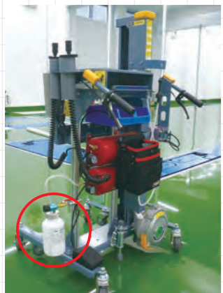
タイヤリフターにブレーキフルードセンサーを設けた特注品
