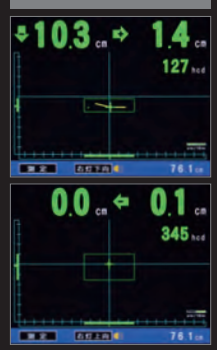
カメラが捉えたヘッドランプ画像を表示せずターゲット (エルボー点) のみ表示します。
