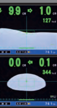
カメラが捉えたヘッドランプ画像を2値化 (白黒) 処理し表示します。
