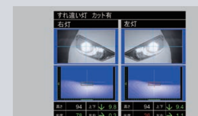
● 測定結果画面③ 測定時の状態を画像で確認できることで測定の間違いに気づきやすい表示
