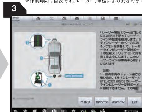
付属のレーザーパーツを使って簡単に車軸のポイントを設定できます。高性能グリーンレーザーを採用していますので、視認性が高くここでも大幅な作業効率アップを図れます。
