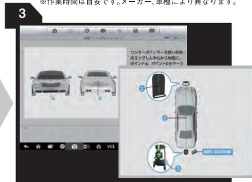
付属のレーザーパーツを使って簡単に車軸のポイントを特定できます。高性能グリーンレーザーを採用していますので、視認性が高くここでも大幅な作業効率アップを図れます。
