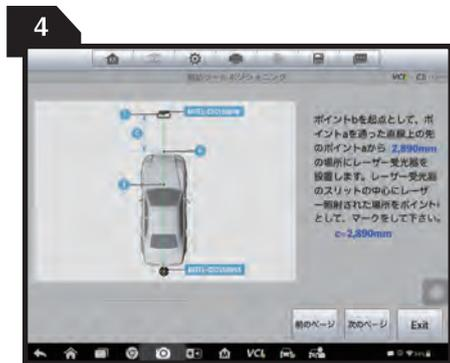
ここでは、リフレクターの設置ポイントまでの算出手順を解説。整備書に基づいて作成された距離 2,890mm という指示がタブレット上に表示されます。
