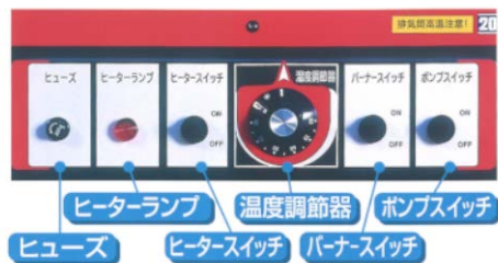
操作パネル部
