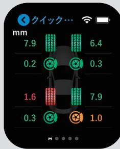
クイックチェックモードは、タイヤとブレーキディスクの同時測定を4か所繰り返し記憶するモードです。このモードでは、**タイヤとブレーキディスクの摩耗を包括的に分析・表示**します。
