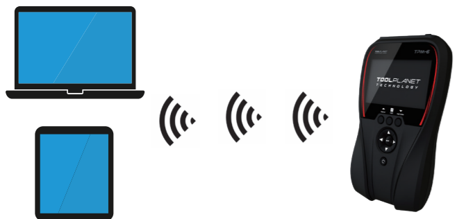
VCI から PC・タブレットまで Bluetooth® による無線接続を実現。
