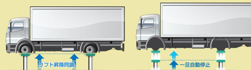
リフト昇降時の固定・移動リフトの同調機能で水平に昇降することが可能。安全性を確保します
