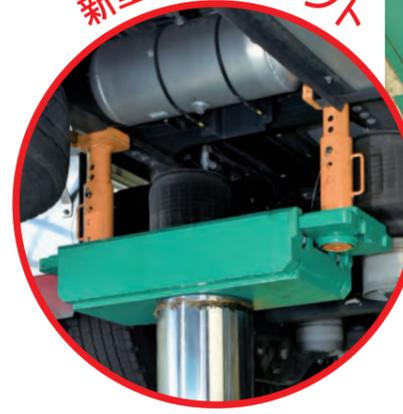
低床車にも対応する進化したアタッチメント。差し込み形状を変更し、ガタツキが少ない・軽量・ラインナップ豊富であらゆる車両に対応します
