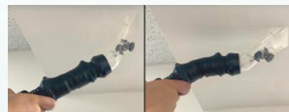
ノズルヘッドはバネ付きで、洗浄面の傾きに応じてスイングします。この特性により、今まで洗浄が難しかった天井や曲面などでも効率的な作業が可能
