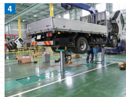
▲「2柱式ツインパワーリフト」は能力12tの中・小型車向け（左）、能力30tの大型車向け（右）ともに車検整備を中心に活用
