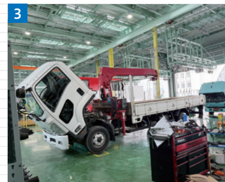
▲連結状態のトラクター＆トレーラーや中・小型トラックの2台同時整備も可能な「4柱式ツインパワーリフト」
