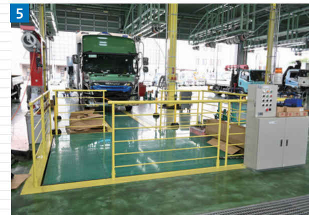
▲「3分割フロアリフト」はクイック整備からパワートレインやシャシの重整備まで立ち姿勢のまま安全かつ高効率に作業可能
