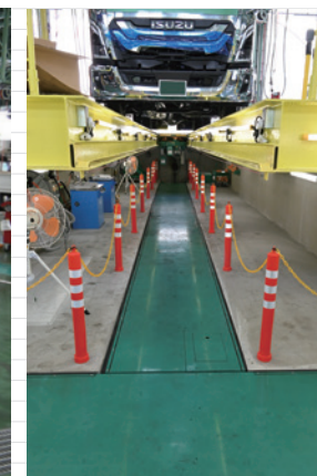
▲「3分割フロアリフト」はクイック整備からパワートレインやシャシの重整備まで立ち姿勢のまま安全かつ高効率に作業可能
