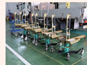
◀立ち姿勢のままホイール脱着可能な“大型車用タッペラーZ”を積極導入し作業負担軽減
