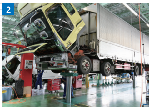
▲「2柱式ツインパワーリフト」は能力12tの中・小型車向け（左）、能力30tの大型車向け（右）ともに車検整備を中心に活用
