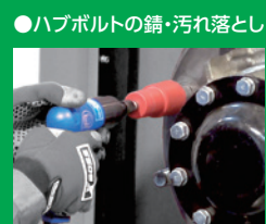
●ハブボルトの錆・汚れ落とし
