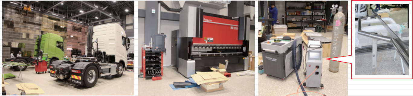
▲金や銅の壁面が目を引く架装工場(左)にはベンディングマシン(中央)などの本格的な加工機を導入し、新製品の試作や特注品の製造に対応。“ファイバーレーザー溶接機”(右)はサビの発生を抑えたステンレス溶接に効果を発揮
