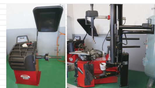
▲タイヤチェンジャーは省スペースモデルのウイングシリーズ。ホイールバルancerは高精度なスタンダードモデル“neo221”でタイヤサービスを構築
