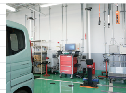
▲“3Dホイールアライメントシステム”を導入。アライメント診断・調整を内製化
