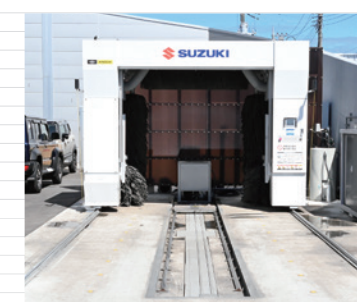
▲防音性と節水を重視し、門型洗車機は“ジズペクトIII”(CMGS400J)を納入
