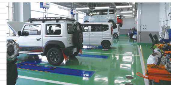
▲8スツールを並列に並べた整備作業場。車両をバックで入庫するのが同社ルール。これにより、構内の事故ゼロに
