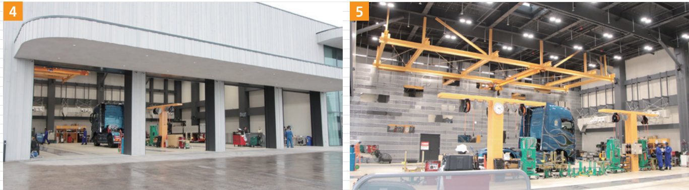
▲サービス工場全景。各ストールに空調を完備のうえ出入口にロールシャッターを設け冷暖房効率をアップ。特注の山吹色で塗装した“自立式リール架台”や“天井走行クレーン”を導入するなど工場美観も最大限追求した
