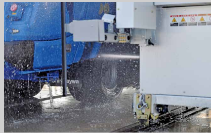
足回りも高圧水で洗浄
